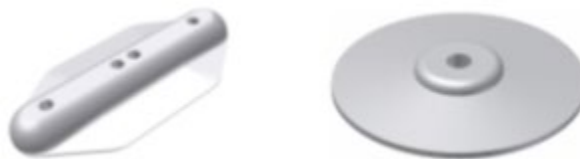
Schéma 1.2 Joint intérieur et disque de verrouillage externe, respectivement
